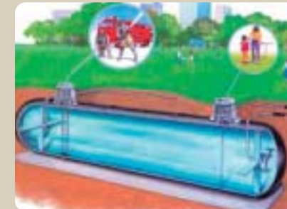
〈飲料水兼用耐震性貯水槽〉
