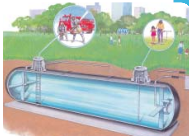
飲料水兼用耐震性貯水槽
