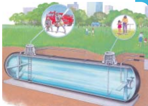
飲料水兼用耐震性貯水槽
