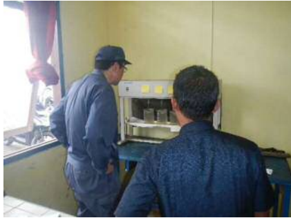
沈殿処理技術確認 (ジャーテスト)
