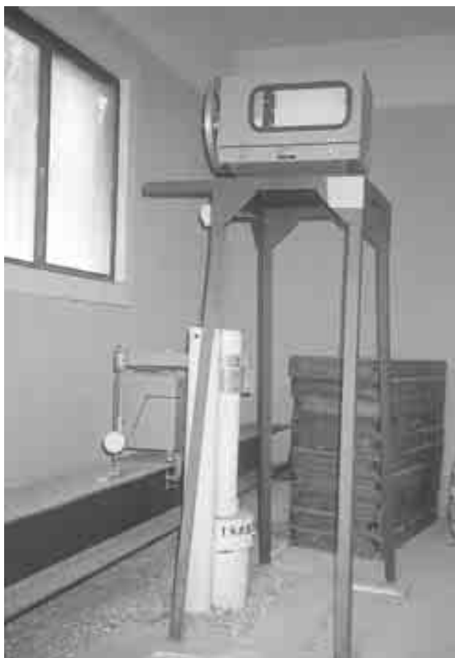
地盤沈下・地下水位調査
