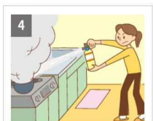
4 住宅用消火器で約12~28秒間薬剤が放射されます！ ※各メーカーによって放射時間は異なりますので、取扱説明書をお読みください。
