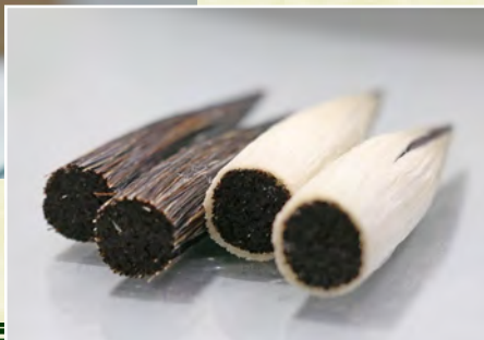
左が上毛を巻く前、右が巻いた後の穂。わずか1mm程度の上毛を均一に巻く繊細な作業に職人技が光る
