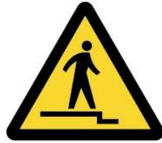
下り段差注意 Caution, uneven access / down
