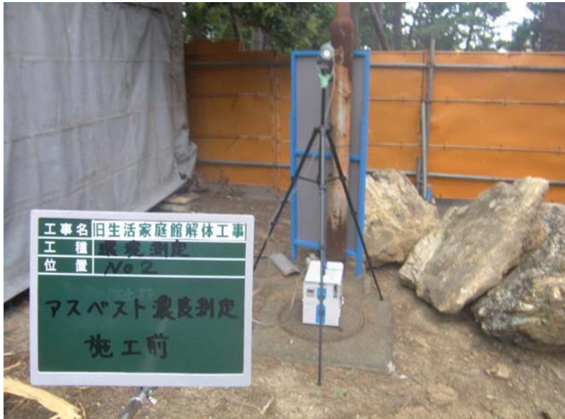
応急措置後のアスベスト粉じん濃度調査（敷地境界付近）
