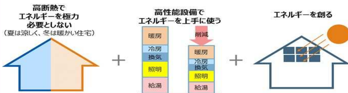
図 6-4 ZEH(ネット・ゼロ・エネルギー・ハウス)イメージ図 出典:資源エネルギー庁ホームページ( https://www.enecho.meti.go.jp/ )
