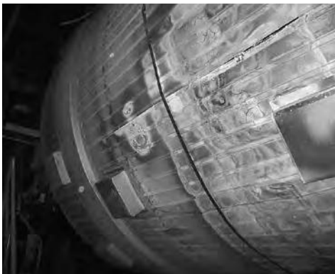
故障した熱分解ドラム
